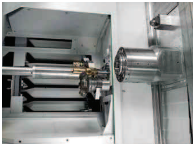
Fase di cambio utensile sul centro di lavoro H 6000
