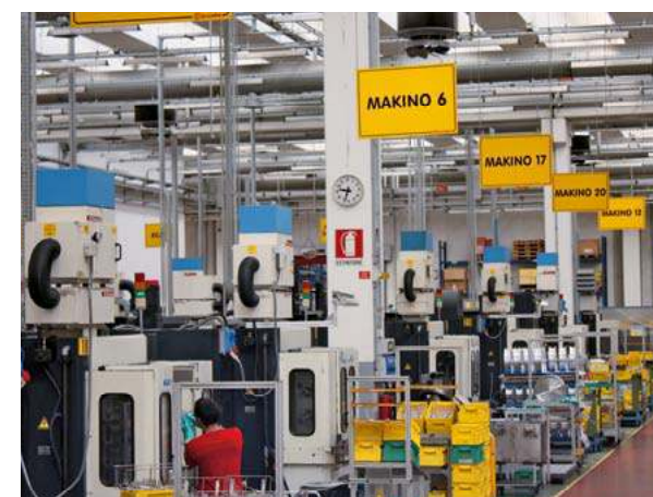
Presso il reparto Moto di Brembo sono installati vari centri di lavoro con i quali vengono realizzate tutte le lavorazioni meccaniche
