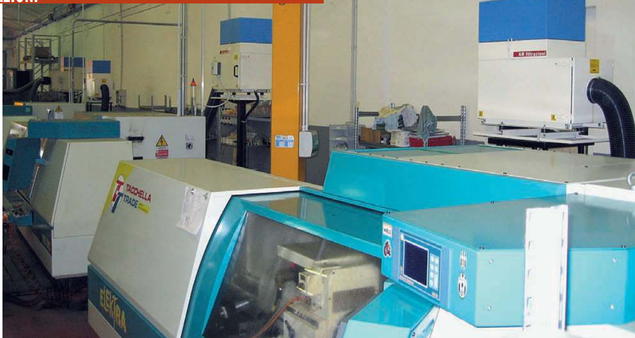
I depuratori appartenenti alla gamma Arno VF sono indicati per l'aspirazione e la depurazione di nebbie d'olio e polveri generate nelle lavorazioni a secco e a umido. Qui un esempio di installazione su macchine rettificatrici.
