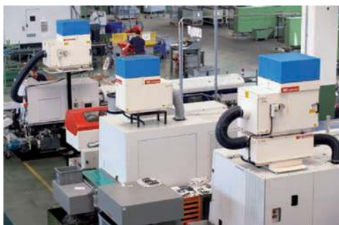
Un altro aspetto dell'officina OMZ: si notano i depuratori d'aria AR Filtrazioni. Nebbie e fumi sono completamente scomparsi.
