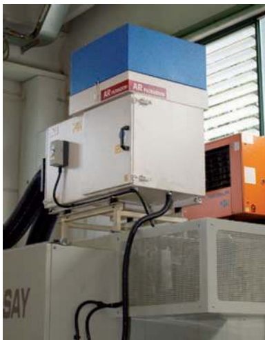
Dettaglio di un depuratore AR serie Arno installato su un tornio automatico.
