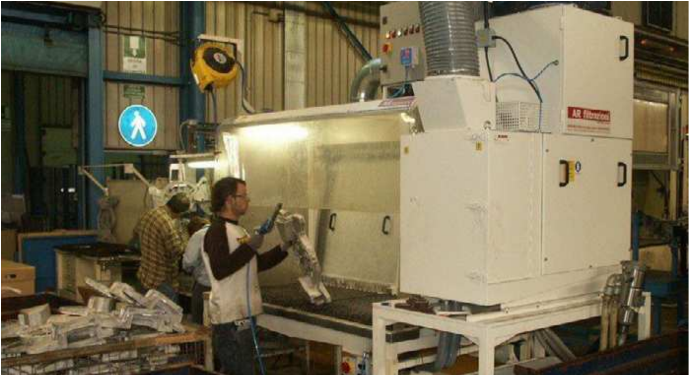
HYDROFILTER e HYDRODESK PER LAVORAZIONI DI SBAVATURA MANUALE A SECCO DEL MAGNESIO
